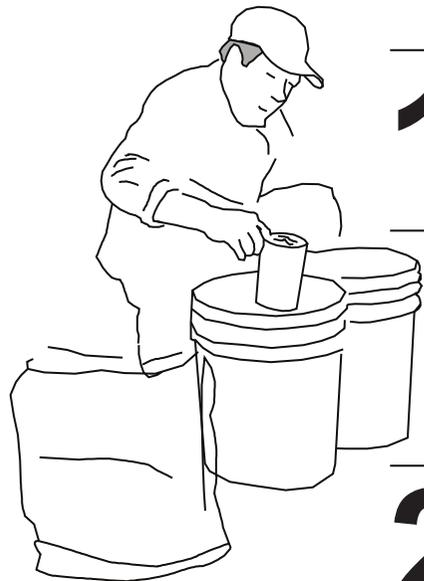
**1** En un balde limpio y seco volcar 1 volumen de componente líquido (provisto en el balde del KIT). A continuación, agregar 0,20 volumen de agua limpia. Mezclar hasta conseguir una masa de consistencia homogénea.
